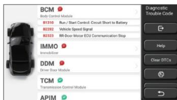
DTCを搭載したシステムでは、画面に赤いフォントが表示され、特定の数のDTCが表示されます。
