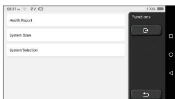
**A. Rapport sur l'état:** ce mode permet de vérifier rapidement le véhicule et d'afficher le rapport de l'état du véhicule (il n'est disponible que lorsque le logiciel de diagnostic prend en charge cette fonction). Après avoir cliqué sur «test rapide», le système commence à numériser le DTC respectivement et affiche le résultat.
