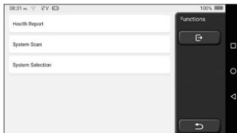
**A. Отчет о работоспособности:** Этот режим предназначен для быстрой проверки автомобиля и отображения отчета о работоспособности автомобиля (он доступен только в том случае, если диагностическая программа поддерживает эту функцию). После нажатия кнопок “Быстрая проверка”, система начинает сканирование DTC соответственно и показывает результат.
