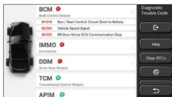
Il sistema con DTC verrà visualizzato sullo schermo nella parte anteriore rossa e verrà mostrato il numero specifico di DTC. Un sistema privo di DTC verrà visualizzato come "OK".
