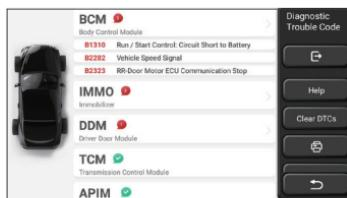
O sistema com DTC será exibido na tela na frente vermelha e o número específico de DTC será exibido. Um sistema sem DTC será exibido como "OK".
