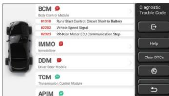
Система с кодами диагностической неисправности (DTCs) будет отображаться на экране красным шрифтом, и будет показано конкретное количество DTC. DTC-бесплатная система будет отображаться как “OK”.
