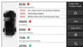
Das System mit DTC wird in roter Schrift auf dem Bildschirm angezeigt, und die spezifische DTC-Nummer wird angezeigt. Ein DTC-freies System wird als „OK“ angezeigt. Klicken Sie auf den Systemnamen, um die spezifische Definition des DTC anzuseigen.
