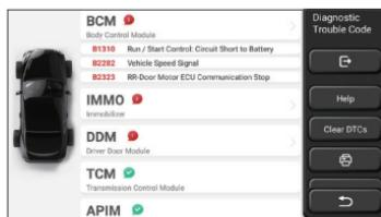
El sistema con DTC se mostrará en la pantalla en letra roja y se mostrará el número específico de DTC. Un sistema sin DTC se mostrará como "OK".
