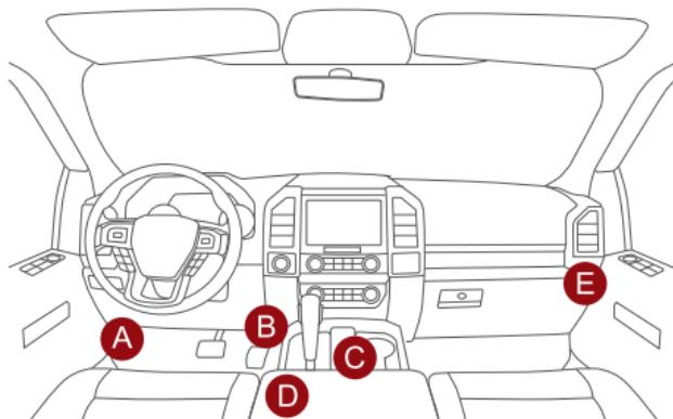
Normalerweise befindet sich der OBD-Anschluss unter dem Armaturenbrett über dem Pedal auf der Fahrerseite. Die fünf im Bild gezeigten Positionen sind übliche OBDII-Port-Positionen.
