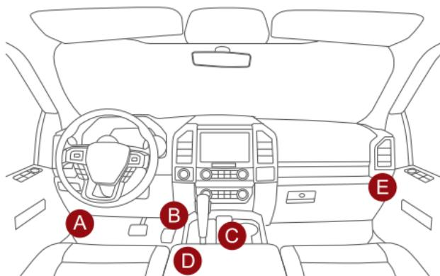
Por lo general, el puerto OBD se encuentra debajo del tablero, arriba del pedal del lado del conductor. Las cinco ubicaciones que se muestran en la imagen son ubicaciones comunes de puertos OBDII.
