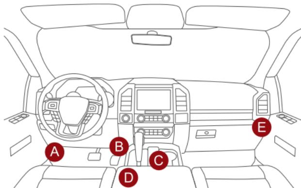
Habituellement, la prise OBD est située sous le tableau de bord, au dessus de la pédale côté conducteur. Les cinq emplacements indiqués sur l'image sont des emplacements de port OBDII courants.
